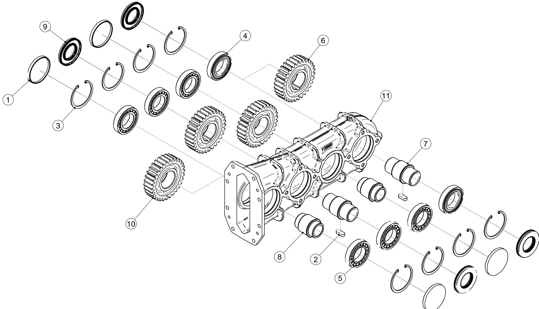
HD GEARBOX DRIVE/РЕДУКТОР ГЛАВНОГО ПРИВОДА/HAUPTANTRIEBSGETRIEBE
