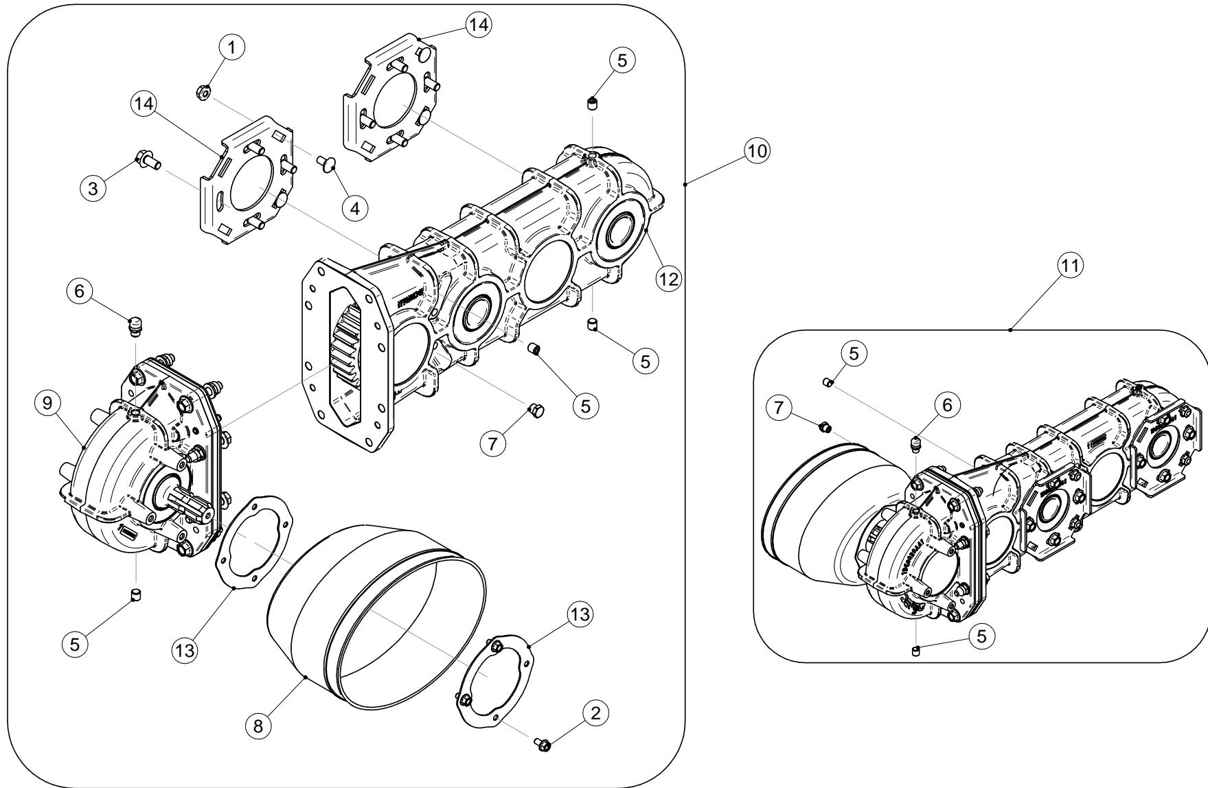
**HD GEARBOX DRIVE/РЕДУКТОР ГЛАВНОГО ПРИВОДА/HAUPTANTRIEBSGETRIEBE**
