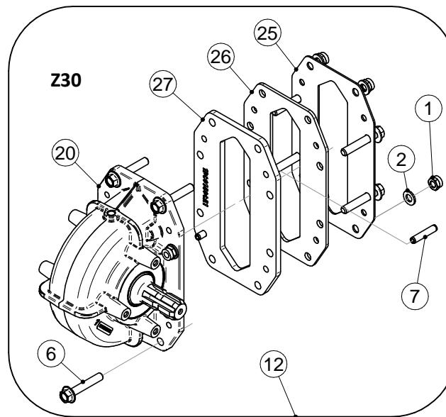
HD GEARBOX DRIVE/РЕДУКТОР ГЛАВНОГО ПРИВОДА/HAUPTANTRIEBSGETRIEBE
