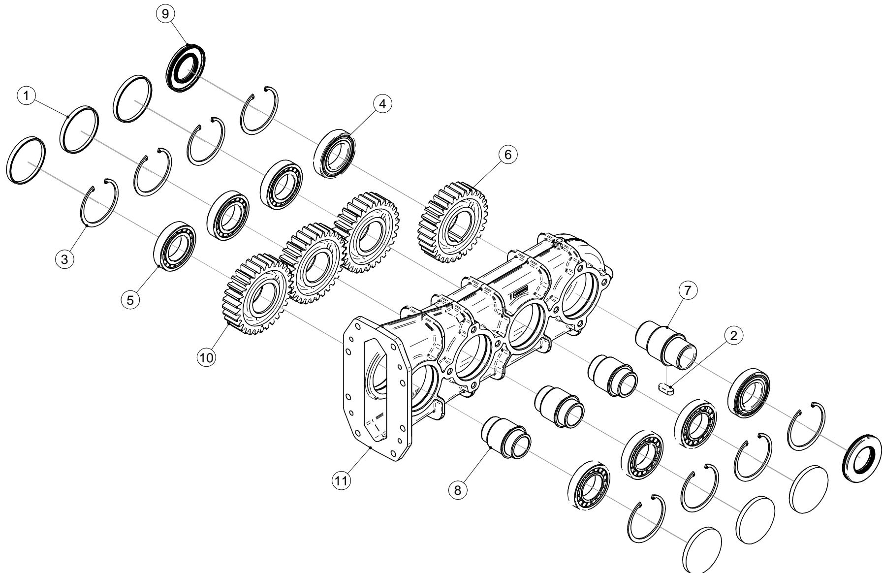
HD GEARBOX DRIVE/РЕДУКТОР ГЛАВНОГО ПРИВОДА/HAUPTANTRIEBSGETRIEBE
