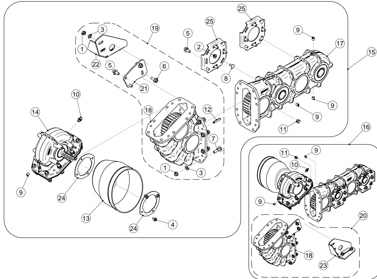
HD GEARBOX DRIVE/РЕДУКТОР ГЛАВНОГО ПРИВОДА/HAUPTANTRIEBSGETRIEBE
