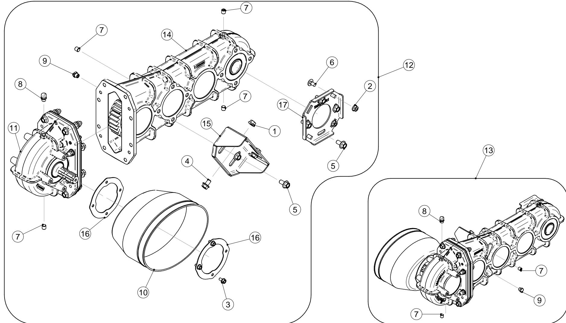
HD GEARBOX DRIVE/РЕДУКТОР ГЛАВНОГО ПРИВОДА/HAUPTANTRIEBSGETRIEBE
