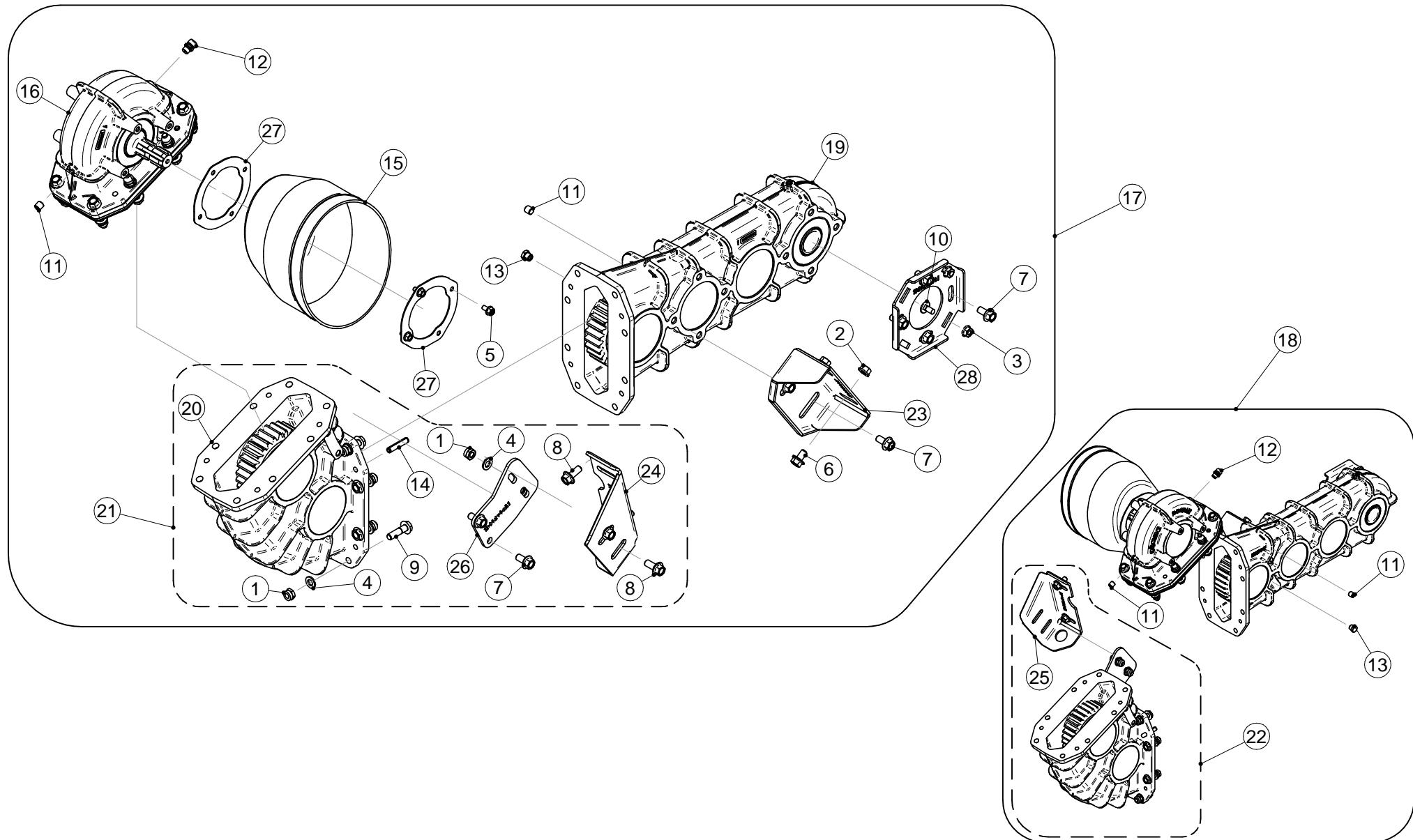
**HD GEARBOX DRIVE/РЕДУКТОР ГЛАВНОГО ПРИВОДА/HAUPTANTRIEBSGETRIEBE**
