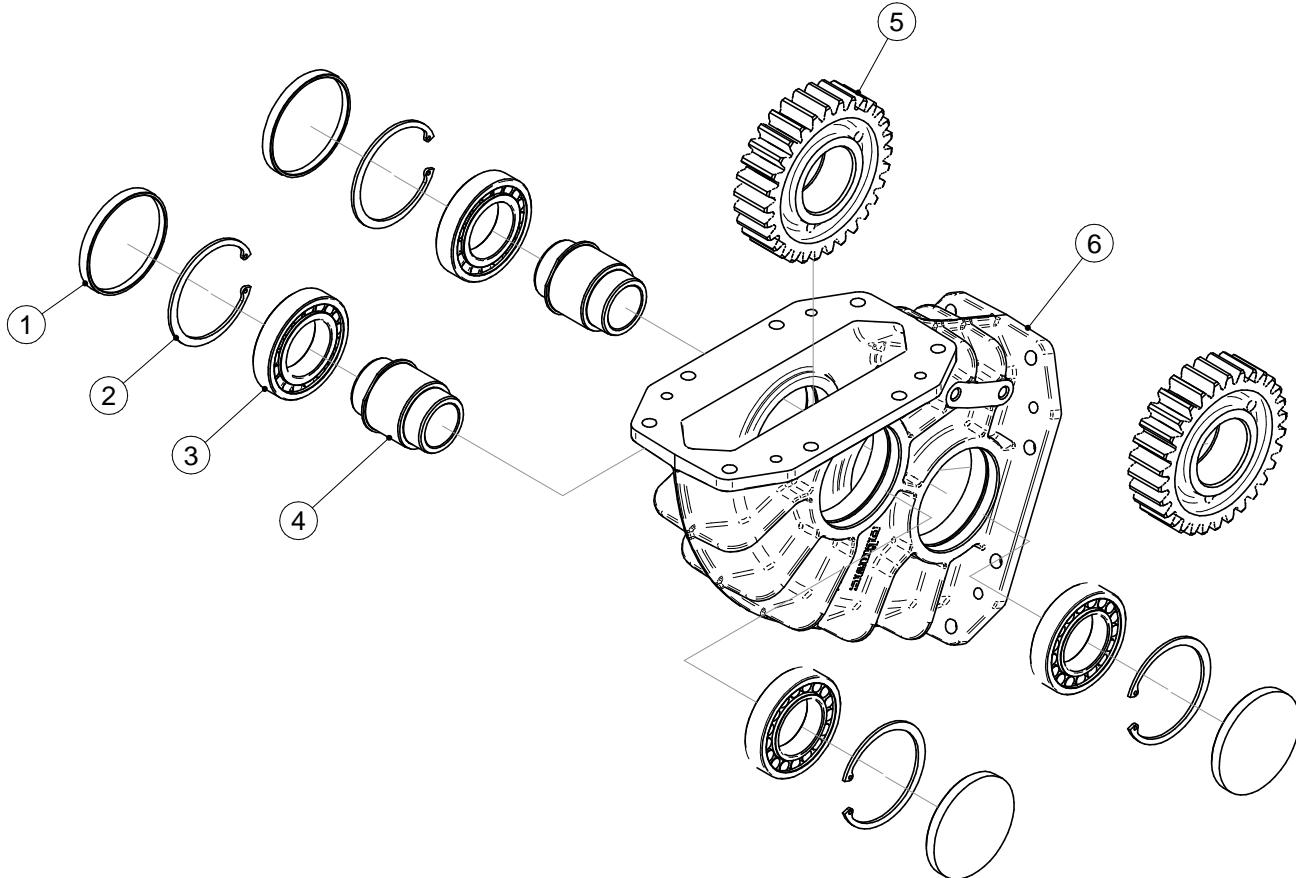
HD GEARBOX DRIVE/РЕДУКТОР ГЛАВНОГО ПРИВОДА/HAUPTANTRIEBSGETRIEBE
