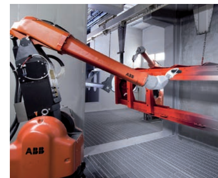
Один из роботов, наносящих лаковое покрытие
