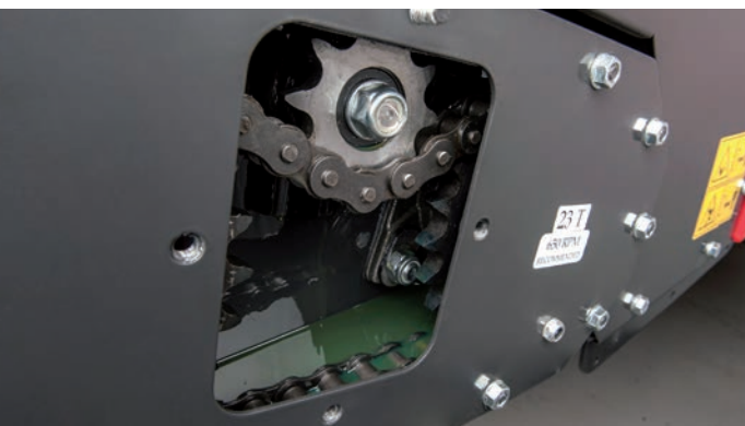
Organe de transmisie în baie de ulei: durată nelimitată, lanțul nu mai trebuie înlocuit.
