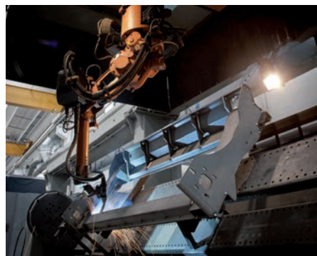
Patru insule de sudură robotizată
