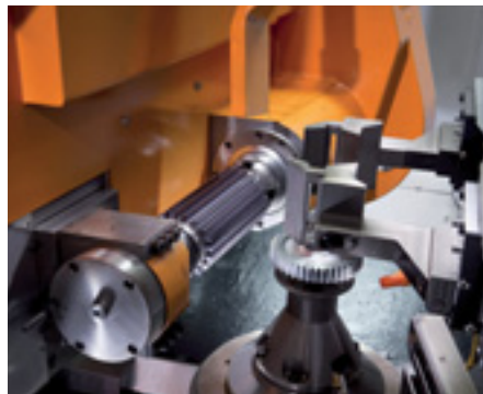
Mașină pentru roți zimțate robotizată, producție angrenaje
