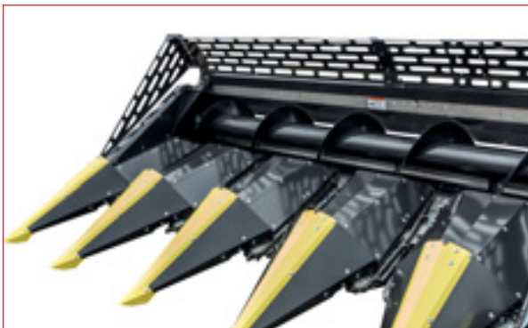
Gratar de protecție împotriva căderii în lateral și în spate
