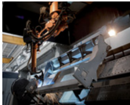
Patru insule de sudură robotizată
