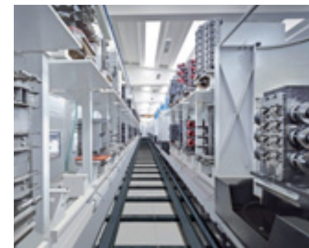
Centru de lucru orizontal: producție de cutii de transmisie și reductoare
