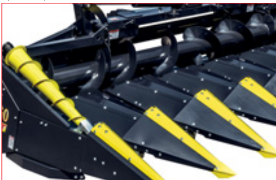
Transmisie spirală cu angrenaje cilindrice cu baie de ulei
