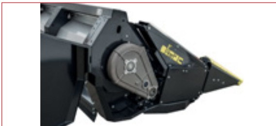
Transmisie spirală cu angrenaje cilindrice cu baie de ulei
