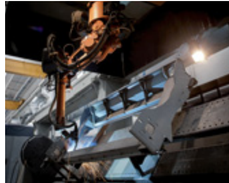
Cuatro islas de soldadura robotizada
