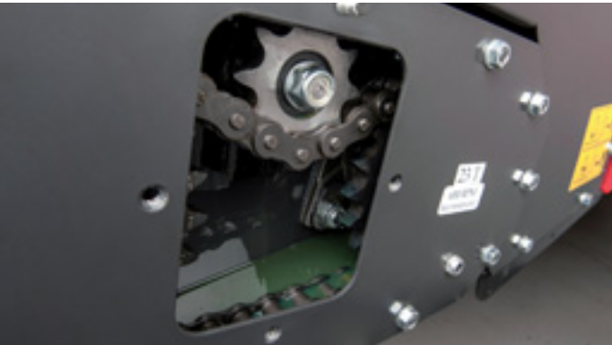
Órganos de transmisión en baño de aceite: duración ilimitada, la cadena ya no debe sustituirse.
