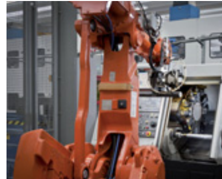
Nueve islas de torneado robotizado
