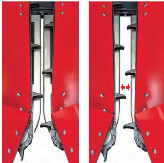
Oni se automatski i istovremeno prilagođavaju veličini stabljike. Automatizam funkcioniše na nezavisan način, na svakom redu:
